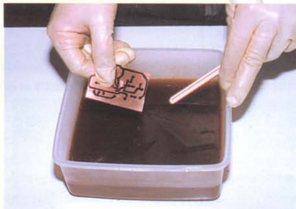
Figura 5.29. La plaqueta se debe sumergir en el percloruro férrico
